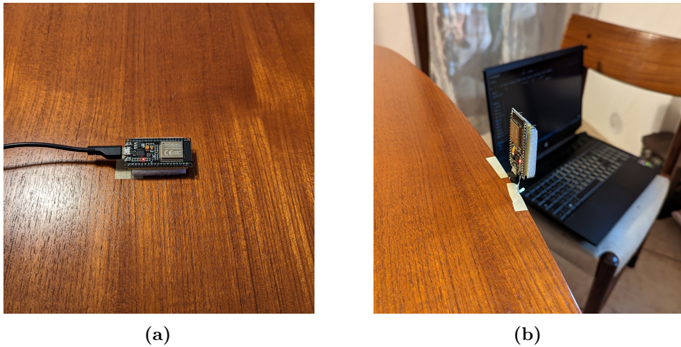
Figura 5.1. Tipi differenti di polarizzazione delle antenne: in (a) l'antenna RX polarizzata orizzontalmente, mentre in (b) polarizzata verticalmente.
